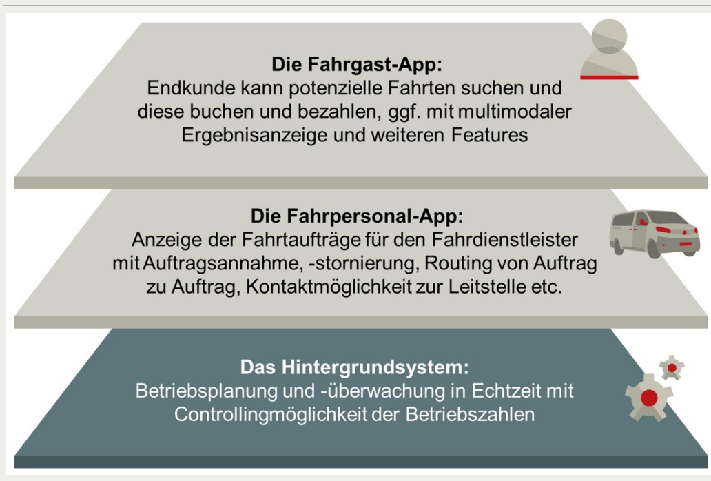
Abbildung 6 – Drei Komponenten einer On-Demand Technologieplattform
