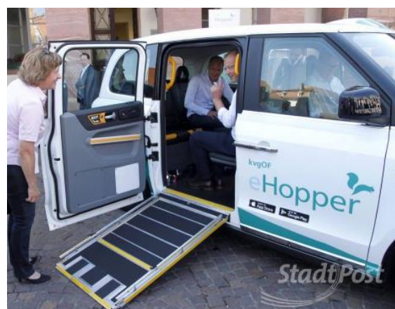
Abbildung 11: ausgeklappte Rollstuhlrampe des LEVC TX (hier im Einsatz als eHopper bei der kvgoF)
